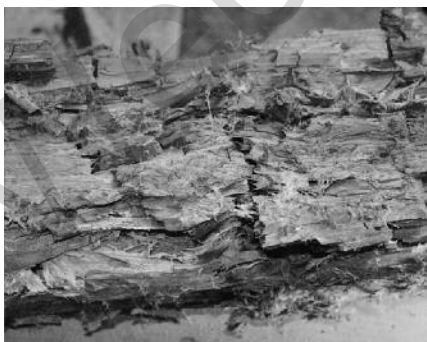
Obr. 1: Ukázka rozpadu dřeva soklu oltáře v kostele v Horním Slavkově po působení dřevokazné houby hnědé hniloby.
