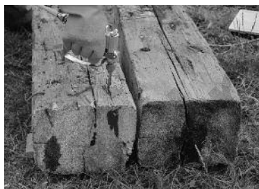
Obr. 13a, b, c: Praktická ukázka chemické tlakové injektáže.
