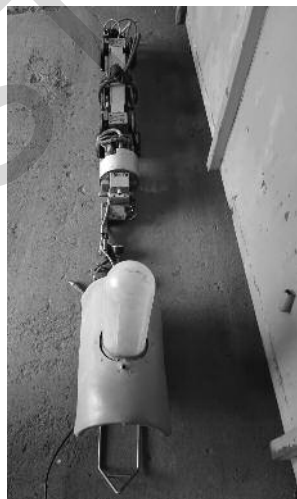
Obr. 3: Robotická sestava pro tmelení přípojek.
