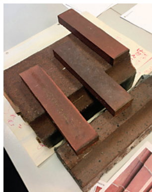
Obr. 10a, b: Keramické fasádní tvarovky původní a nové, hledání textury a barvy materiálu.
