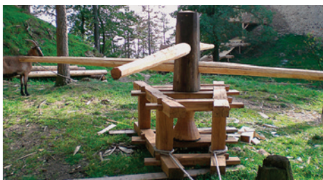
Obr. 2: Rumpál – dřevo je univerzální stavební materiál, v minulosti bylo zcela běžně používáno i na výrobu různých jednoduchých i složitějších strojů – jeřábů, pohonných jednotek, převodů apod. Na snímku jednoduchý rumpál se vvislou osou otáčení použitý pro stavební práce na hradě Točnick. (Foto autor)
