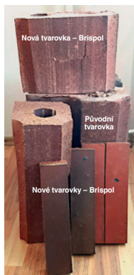
Obr. 10a, b: Keramické fasádní tvarovky původní a nové, hledání textury a barvy materiálu.
