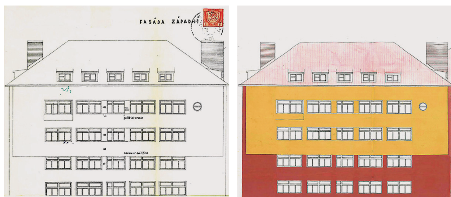
Obr. 3a, b: Západní průčelí: a – materiálové řešení s vyznačením Membranitu, b – návrh barevnosti (r. 1937). [2]
