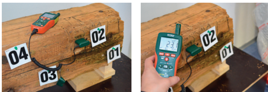
Obr. 5: Měření vlhkosti v místech injektorů vpichovým dielektrickým vlhkoměrem (Thermo Sanace s.r.o.).
