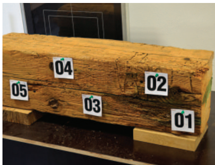
Obr. 3a: RTG diagnostika stavu vnitřní struktury trámů po aplikaci tlakové injektáže chemickou látkou na trám č. 4 (Thermo Sanace s.r.o.).
