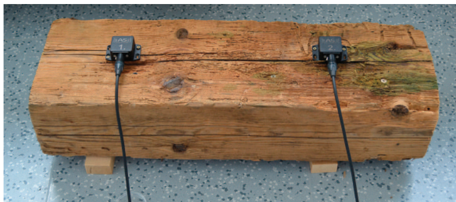
Obr. 4a: Akustická detekce aktivity larev hmyzu systémem Acoustic Pack – trám č. 5 (Thermo Sanace s.r.o.).
