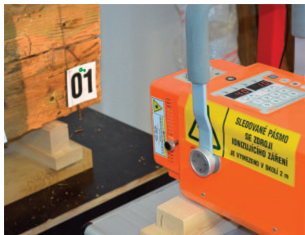
Obr. 3a: RTG diagnostika stavu vnitřní struktury trámů po aplikaci tlakové injektáže chemickou látkou na trám č. 4 (Thermo Sanace s.r.o.).
