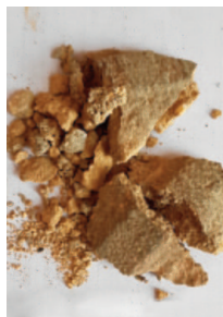
Obr. 8: Omítka okrová – jádro.
