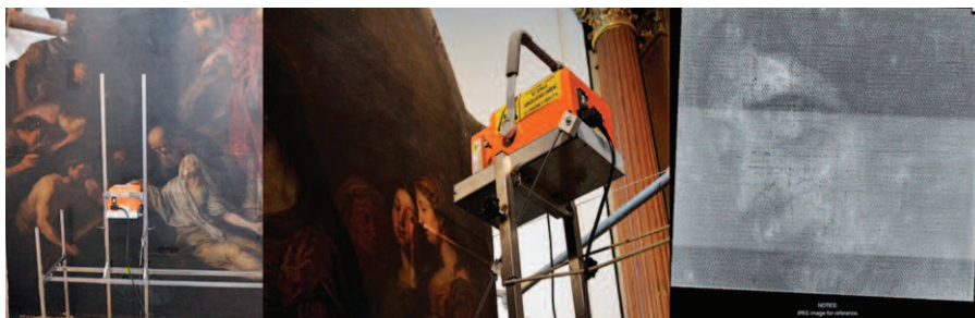
Obr. 3: RTG analýza oltářního obrazu v kostele Nalezení sv. Kříže při kapucinském klášteře v Brně ve spolupráci s Moravskou galerií v Brně.
