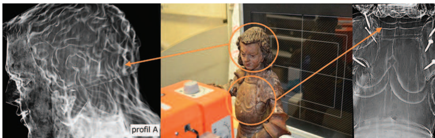
Obr. 4: RTG diagnostika spojení jednotlivých částí dřevěné sochy sv. Jiří s kopím.
