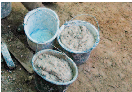
Obr. 6: Vápenná malta s metakaolinem.
