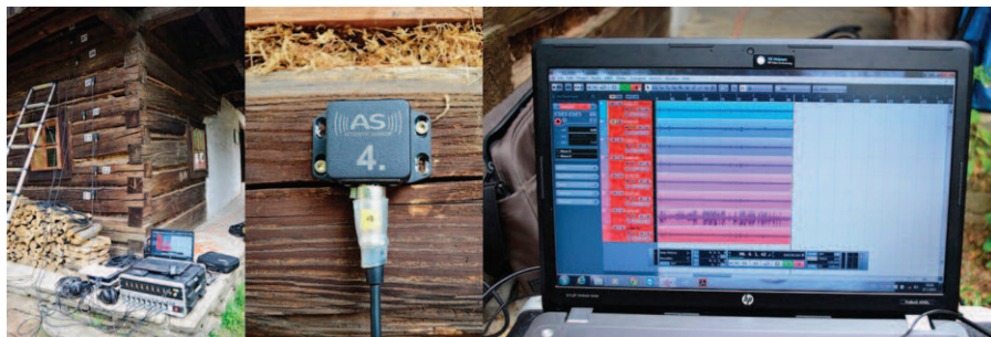
Obr. 9: Ukázka akustické detekce aktivity larev v dřevěných prvcích roubení chalupy z Prlova ve Valašském muzeu v přírodě, Rožnov pod Radhoštěm.
