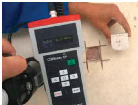
Obr. 7: Posuzování přídržnosti omítek pomocí odtrhového přístroje.
