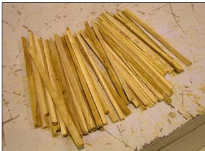
Obr. 5 Zkušební vzorky – pevnost v tahu podél vláken
