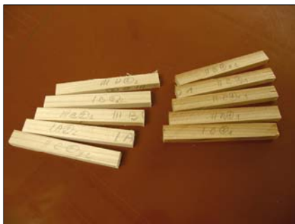
Obr. 7 Zkušební vzorky – přerážecí práce
