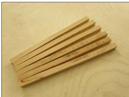
Obr. 6 Zkušební vzorky – pevnost v ohybu
