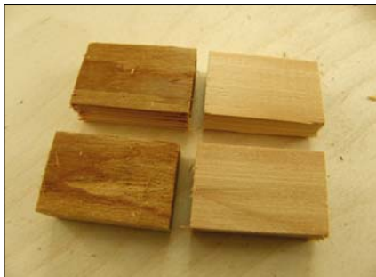
Obr. 4 Zkušební vzorky – pevnost v tlaku podél vláken
