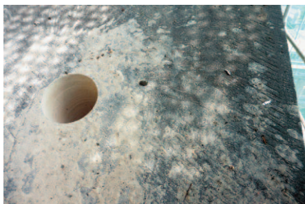
Obr. 6: Praha, Národní muzeum. Odběr vzorku pro fyzikální zkoušky (Kloknerův ústav, 2016).
