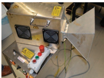
Obr. 1–4: Simulace útlumu amplitudy EM vlny při průchodu dřevem, ukázka mobilního zařízení pro MW sanaci dřevěných prvků konstrukcí a termogramy zobrazující absorpci MW energie a rozložení EM pole.
